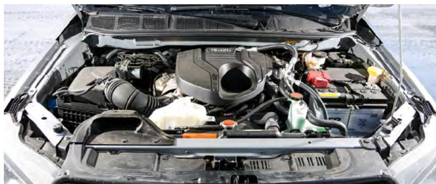
Le 4-cylindres diesel de 1,9 litre est une évolution de la précédente mouture. Il doit désormais composer avec un réservoir d'AdBlue...
