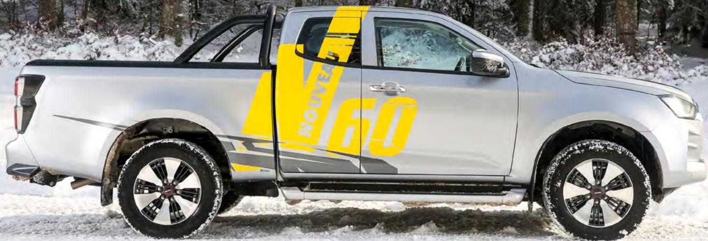
qui est en net progrès. Malgré le recours à un classique essieu arrière rigide et des ressorts à lames, les tressautements encore perceptibles sur la précédente génération ne sont plus qu'un mauvais souvenir, même à vide. Les nouveaux amortisseurs font leur travail avec application et la prouesse est d'autant plus remarquable que la charge utile demeure supérieure à une tonne, soit une des meilleures valeurs de la catégorie.
