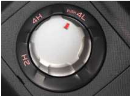
Enclenchement du mode 4x4 et utilisation des rapports réduits par simple molette située sur le tunnel central
