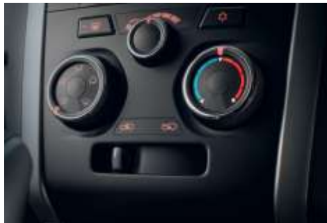
Régulation manuelle de la climatisation.
